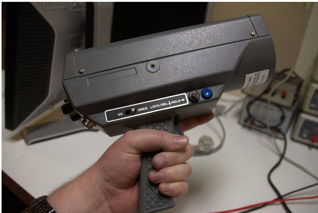
Slika 8 Radarski pištolj kamera
