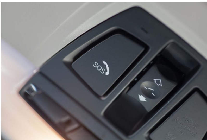
Slika 5 Primjer izgleda gumba u vozilu za poziv hitne službe 112
