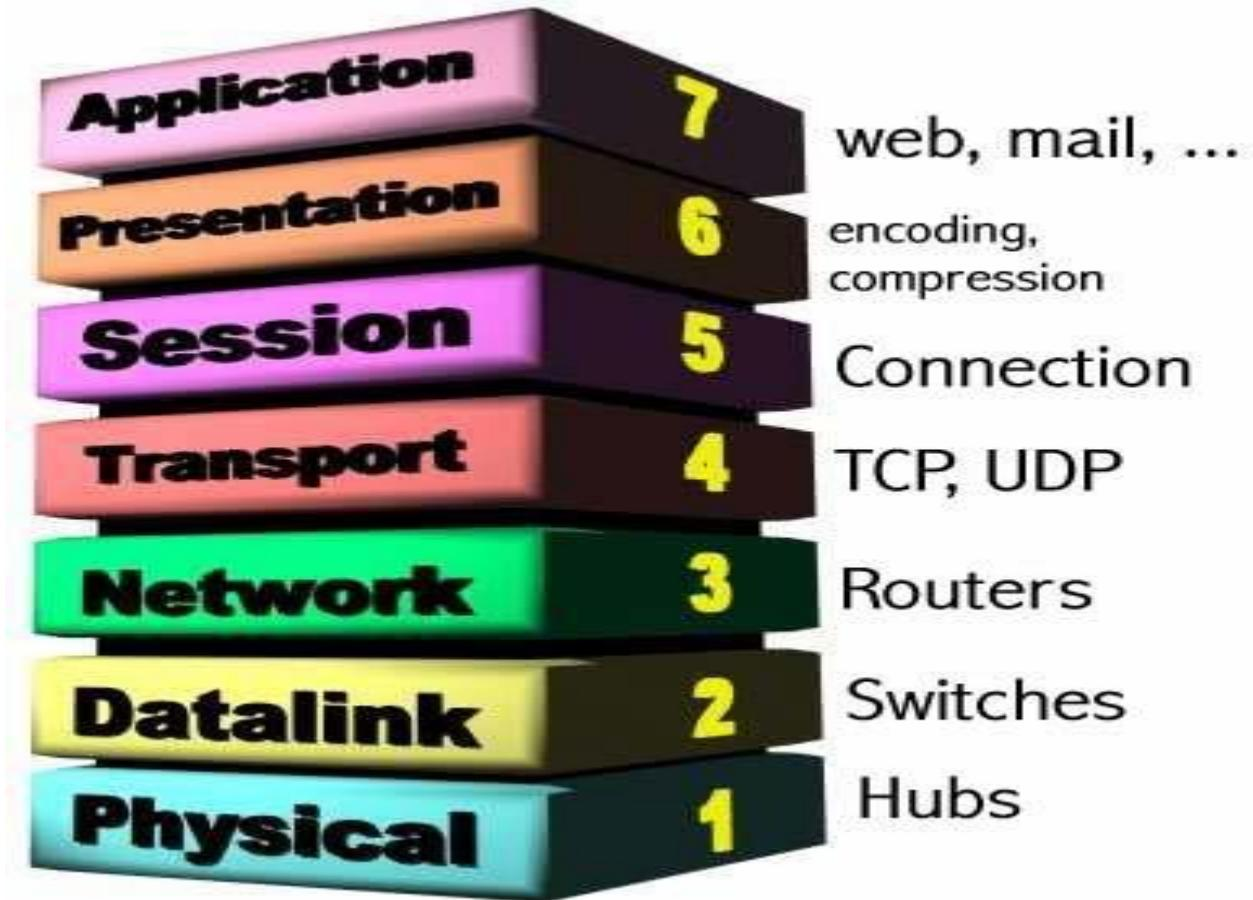
Slika 2.Prikaz razvoja 7 slojeva Osi modela, Izvor: [https://www.researchgate.net/figure/Relation-Between-The-OSI-Model-And-The-Grid-Layers-Model\\_fig1\\_239601903](https://www.researchgate.net/figure/Relation-Between-The-OSI-Model-And-The-Grid-Layers-Model_fig1_239601903) (21.01.2022.).
