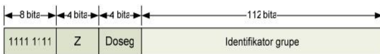
Slika 25. Prikaz strukture IPv6 višeodredišne adrese, Izvor: https://www.cert.hr/wp-content/uploads/2006/11/CCERT-PUBDOC-2006-11-173.pdf (26.01.2022.)
