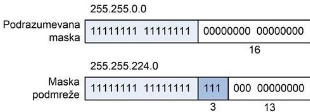
Slika 38.Prikaz određivanja maske podmreže, Izvor: <https://slidetodoc.com/tcpip-model-adresiranje-tcpip-tcpip-o-o-internet/> (14.01.2022.)
