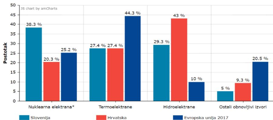
Slika 2 Udjeli proizvedene el. energije po vrstama proizvođača
