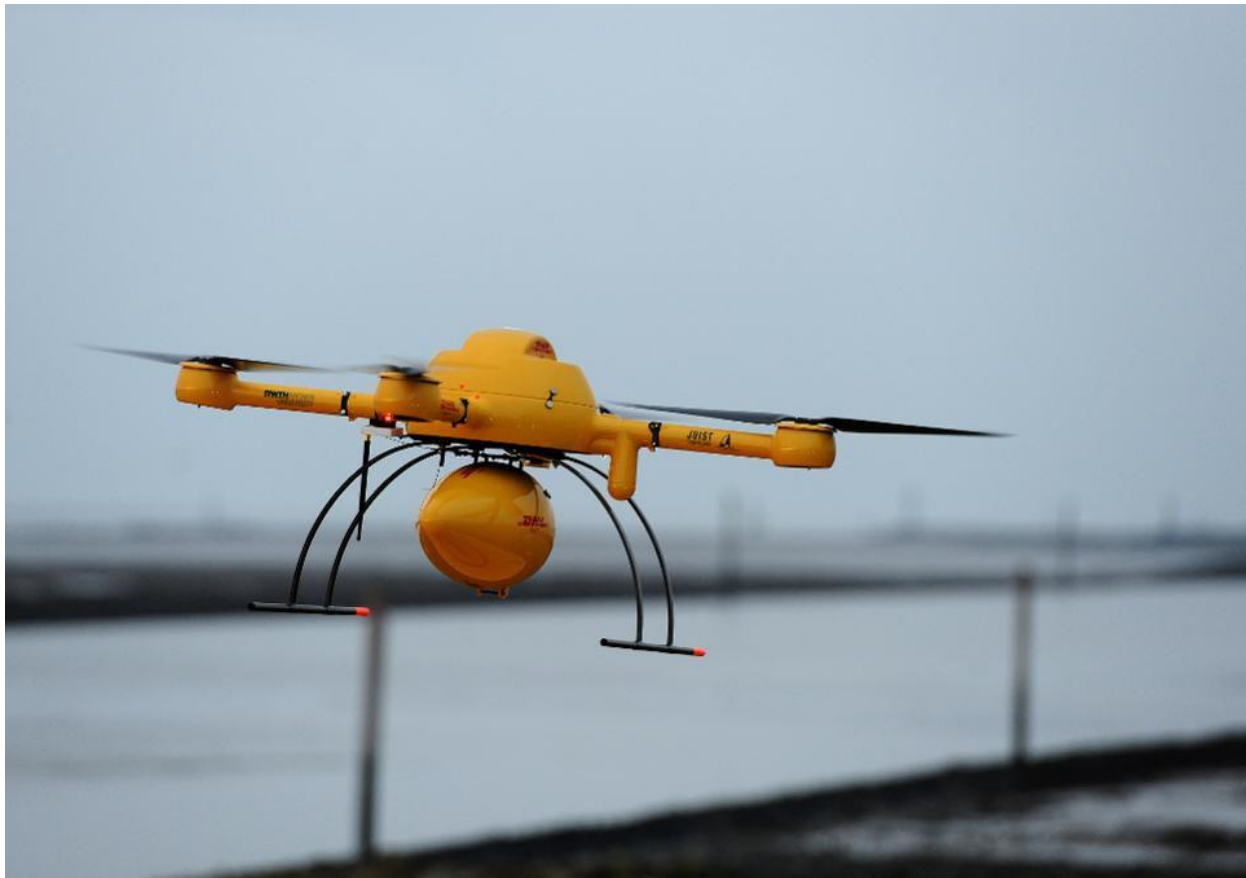
Slika 12 Slika parceloptera, drona za dostavu pošiljki
