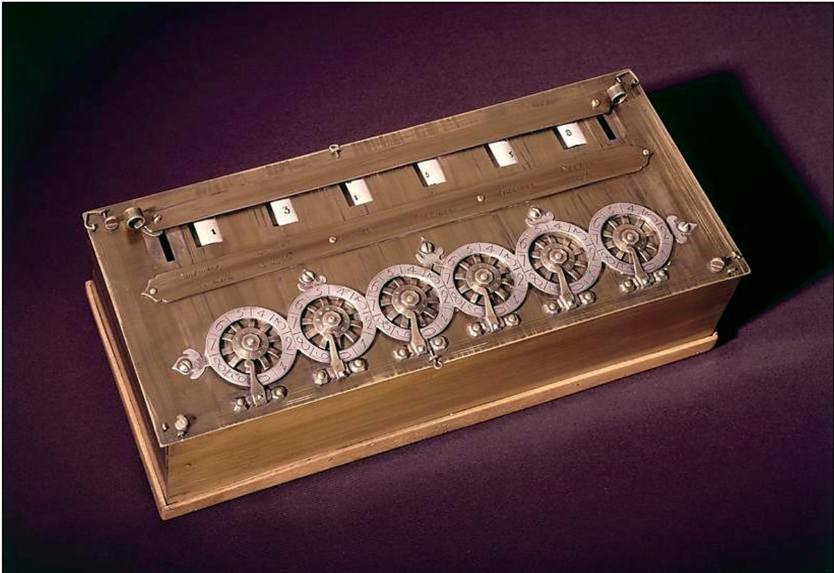
Slika 8. Pascalov mehanički kalkulator
