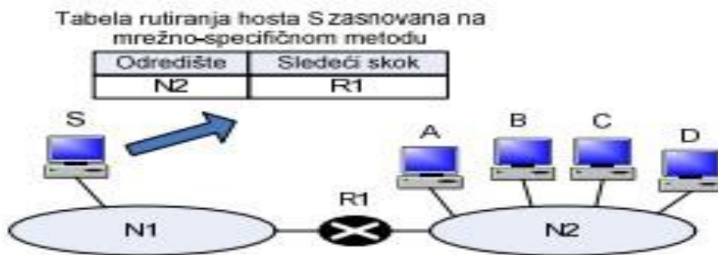
Slika 48. Prikaz mrežno-specifične metode, Izvor: https://brakussale.wordpress.com/2013/02/28/isporuka-prosledivanje-i-rutiranje-ip-datagrama/ (12.01.2022.)
