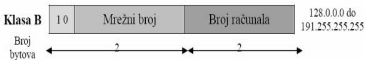
Slika 30. Prikaz klase B, Izvor: http://www.phy.pmf.unizg.hr/~dandroic/nastava/ramr/poglavlje_3.pdf (24.02.2022.)
