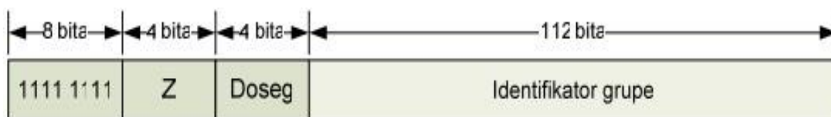
Slika 25. Prikaz strukture IPv6 višeodredišne adrese, Izvor: https://www.cert.hr/wp-content/uploads/2006/11/CCERT-PUBDOC-2006-11-173.pdf (26.01.2022.)
