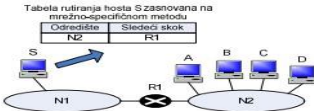
Slika 48. Prikaz mrežno-specifične metode, Izvor: https://brakussale.wordpress.com/2013/02/28/isporuka-prosledivanje-i-rutiranje-ip-datagrama/ (12.01.2022.)
