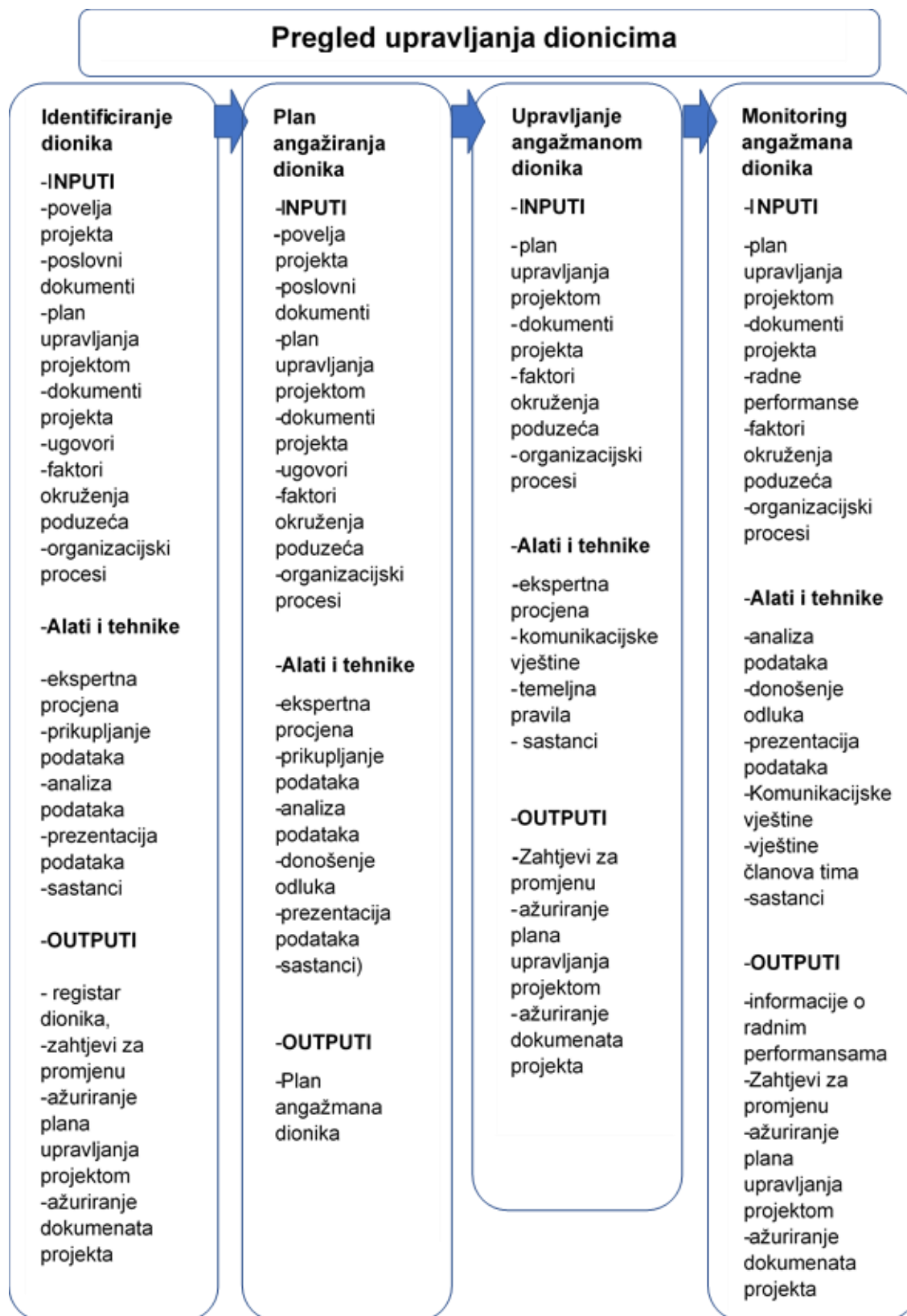
Slika 14. Shematski prikaz procesa upravljanja dionicima
