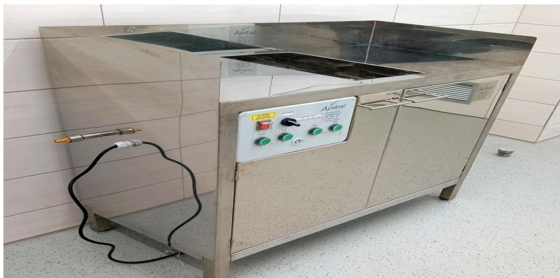
Slika 25 Stroj za pranje i sušenje staklenki
