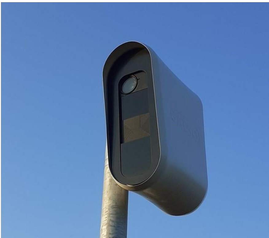
Slika 11 Kamera za mjerenje brzine kretanja vozila, ali i snimanje drugih prometnih prekršaja
