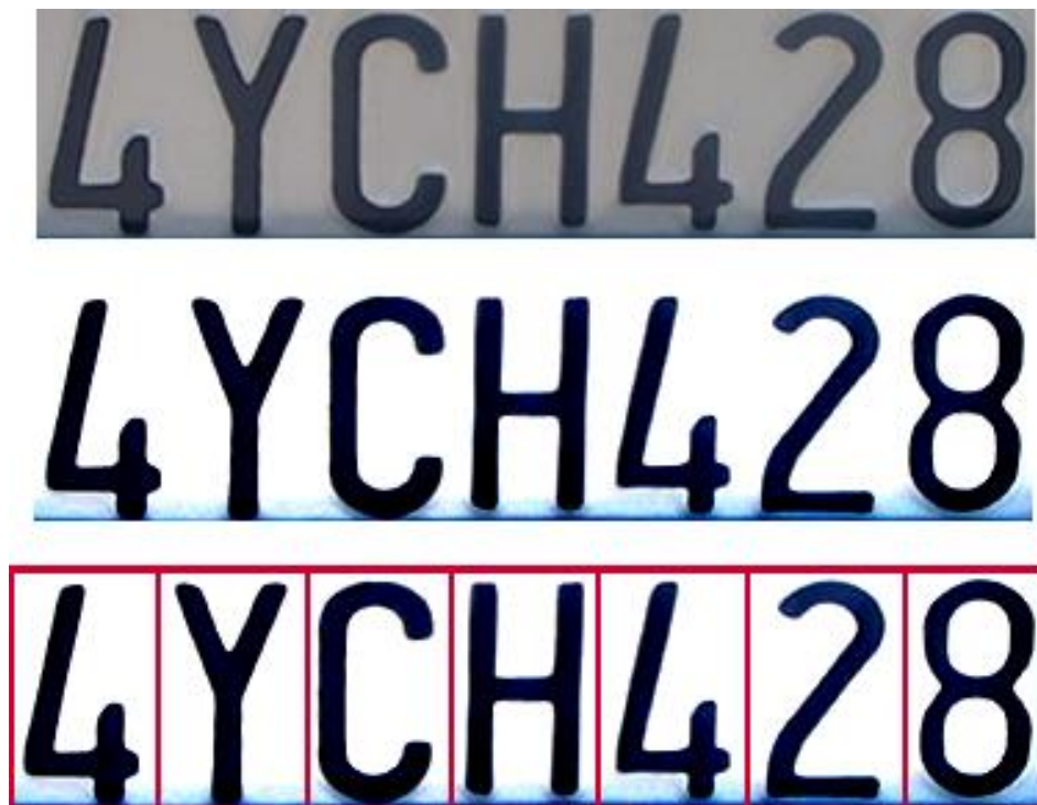
Slika 6 Proces pripreme slike registarske oznake za optičko prepoznavanje teksta – određivanje jačine osvjetljenja i kontrasta, izdvajanje pojedinačnih slova i brojki
