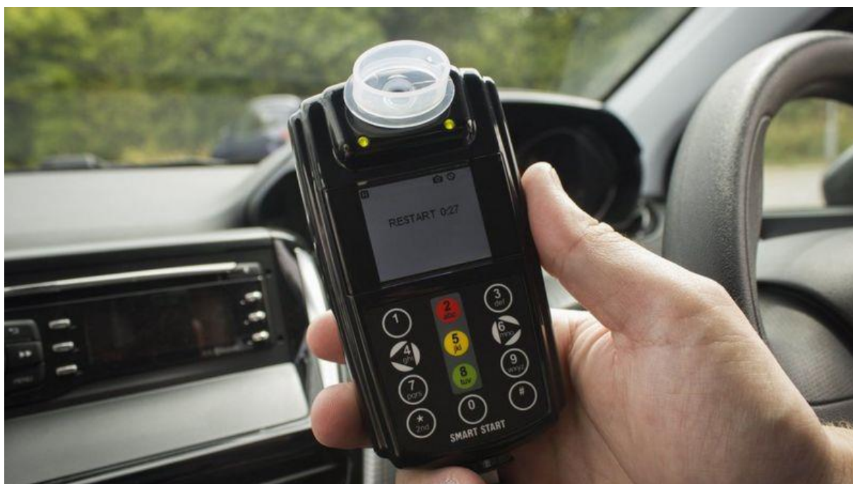
Slika 12 Uređaj za blokadu u slučaju vožnje pod utjecajem alkohola
