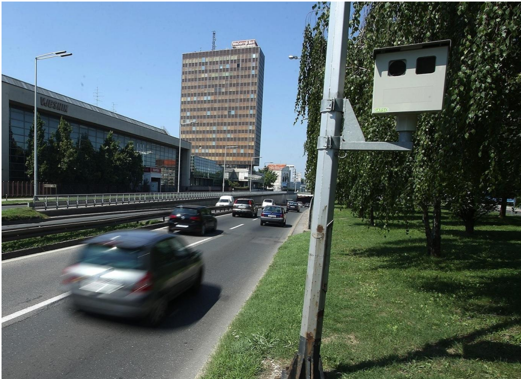
Slika 10 Kamera za mjerenje brzine kretanja vozila
