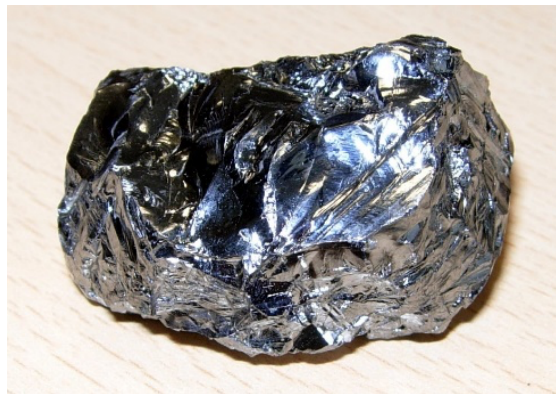
Slika 1 - Komadić pročišćenog silicija
